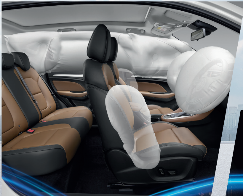
ถุงลมนิรภัย 6 จุด คู่หน้า ด้านข้าง และม่านถุงลมนิรภัย
