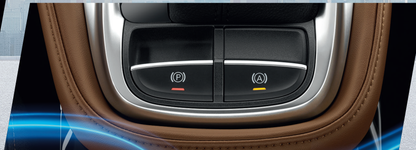
ระบบเบรกมือไฟฟ้า EPB และระบบป้องกันการไหลของรถ โดยไม่ต้องเหยียบเบรกค้าง AVH
